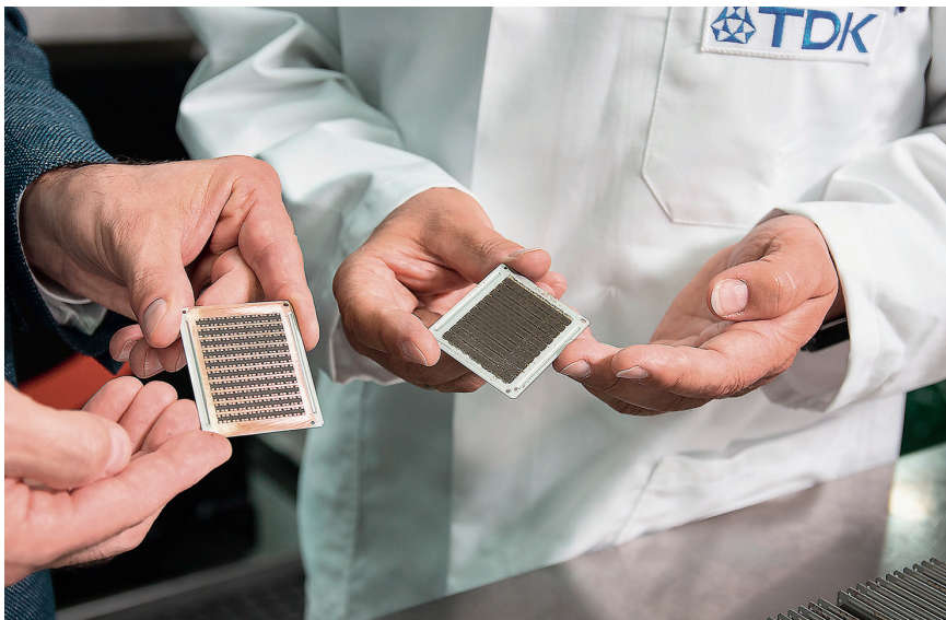
4 Die Platinen mit den Mikro-Induktivitäten vor und nach der Feinschleifbearbeitung
